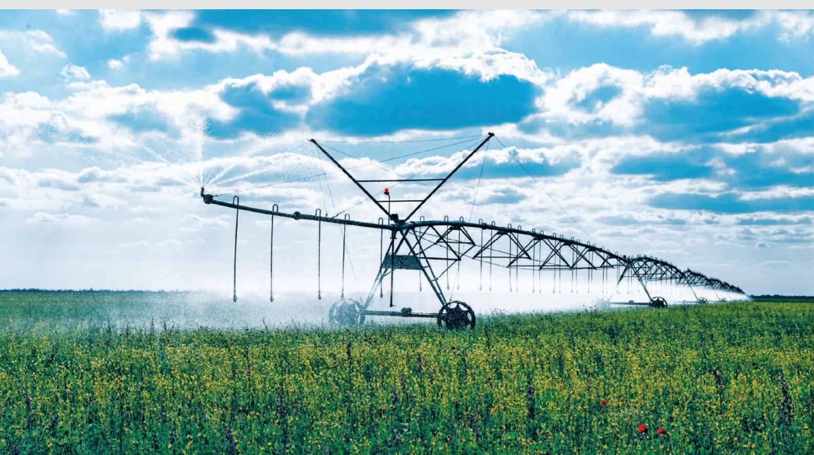
**Дождевальная машина «Кубань» представляет собой вращающийся вокруг неподвижной опоры водопроводящий трубопровод, выполненный в виде отдельных пространственных ферм, соединенных между собой шарнирными соединениями и опирающихся на двухколесные электроприводные передвижные опоры с колесами. Конец трубопровода выполнен в виде консоли. Конструктив машины выполнен из стали, обработанной методом горячего цинкования.**
