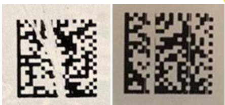
Нарушение целостности КМ*
